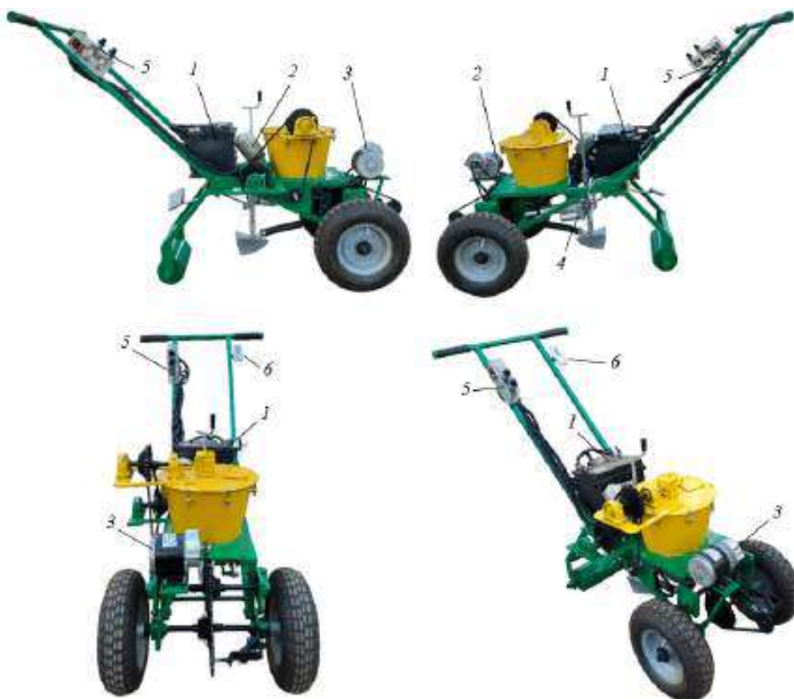
Рисунок 1 – Гидросеялка ГНОМ-1 автоматизированная с электрическим приводом мешалки:
