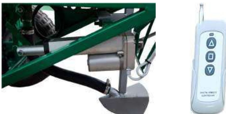
Рисунок 2 – Электропривод заслонки с пультом дистанционного управления
