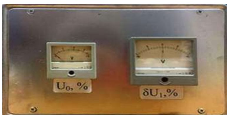
Рисунок 1 – Внешний вид прибора для измерения относительных значений отклонения напряжения прямой и нулевой последовательности сети 0,4 кВ
