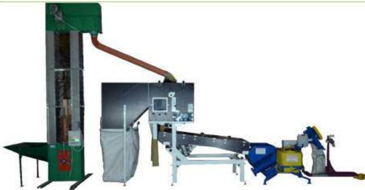
Рисунок 3 – Селекционный семяочистительный комплекс
